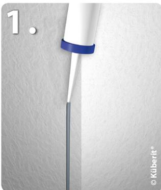
**Wandprofil** mit geeignetem Klebstoff befestigen. Der Untergrund muss fest, trocken und sauber sein! Profil ansetzen und fest andrücken (1). Dank der **Sollbiegestellen** ist ein angleichen der Profile an Unebenheiten möglich.
