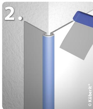
Zur Vermeidung von Ansätzen wird das **Wandprofil** nach Antrocknung des Klebers mit geeigneter Spachtelmasse angespachtelt (2).
