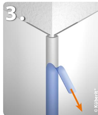
Die **Schutzfolie** möglichst vor der Verlegung des Wandbelags entfernen (3).
